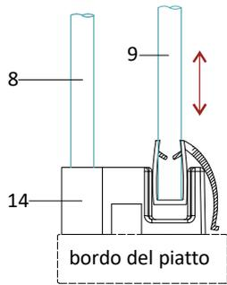
Stabilire la posizione di montaggio dei montanti tenendo conto che tutti i componenti dovranno essere installati sul bordo del piatto doccia, se presente.
