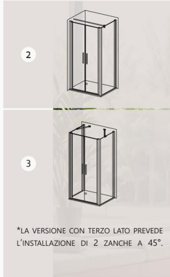
\*LA VERSIONE CON TERZO LATO PREVEDE L'INSTALLAZIONE DI 2 ZANCHE A 45°.
